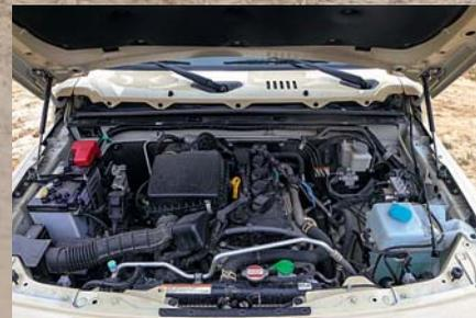
Атмосферник K15B с распределенным впрыском требует бензин АИ-95. Уплотнитель проложен только сзади, поэтому моторный отсек быстро загрязняется. Аккумулятор удивил скромной емкостью – всего 45 А·ч.
