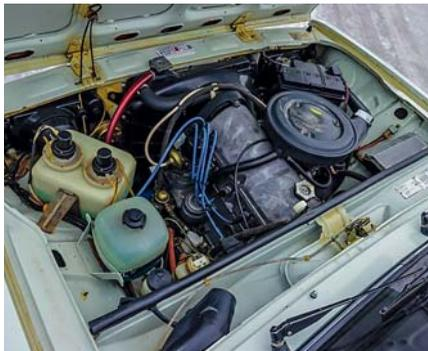
По отдаче 1300-кубовый мотор VAZ-2105 уступает «троечному» объемом полтора литра. Зато по части тишины работы его ременный привод ГРМ несравнимо приятнее цепи. Внешне двигатель легко отличить по алюминиевой клапанной крышке и отдельной крышке ремня ГРМ.
