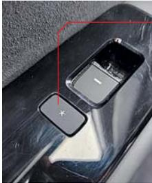
Сначала подумал, что **клавиша со звездочкой** на задней дверной карте включает обогрев. Оказалось, что в распоряжении каждого пассажира есть такая. И активирует она голосовое управление медиасистемой. Неожиданно, когда кто-то сидящий на галерке вдруг командует без одобрения водителя.
