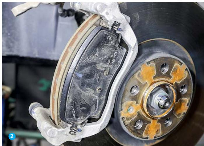
При установке декоративной крышки на место смажьте направляющие силиконовой смазкой.
