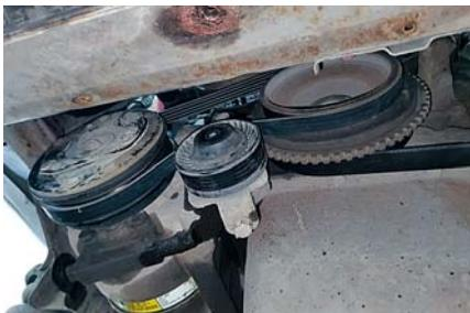
Чтобы добраться до ремня и роликов (не только для замены, но и для регулировки), приходится снимать все листы защиты снизу. Сверху доступа нет.
