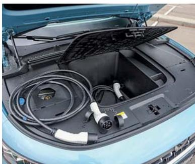
Зарядные провода удобно хранить в дополнительном багажнике под капотом.
