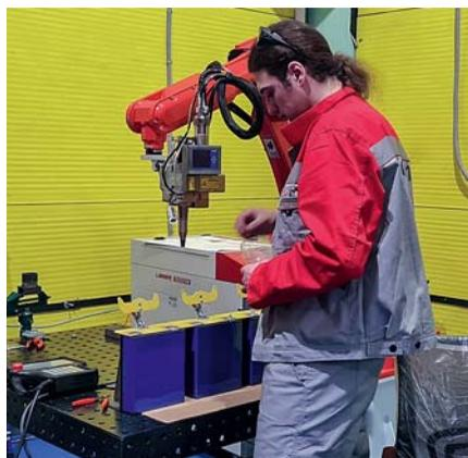
Литий-железо-фосфатные ячейки закупаются в Китае. Выходные электроды наплавляются уже у нас. Тяговая батарея состоит из десяти сегментов, по 12 ячеек каждый.
