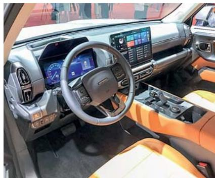
Haval Xiaolong длиной 4600 мм – одноклассник Dargo. Типовой в целом салон разбавляют два решения. За смену режимов трансмиссии отвечает рычажок под рулем, а его место на центральной консоли заняли ниши под пару смартфонов. Кроссовер представляет собой переднеприводный гибрид максимальной отдачей 190 сил с запасом хода на электричестве чуть меньше 100 км.
