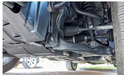
Нижние рычаги передней двухрычажки – стальные, массивные, с руку толщиной. Сзади – мост на пружинах с тягой Панара. Задние тормоза – вентилируемые.
