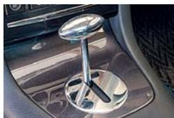
Изначально ISV был с механической вазовской коробкой, но потом был установлен пятиступенчатый автомат BMW. Селектор – оригинальный.
