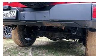
Короткие бамперы обеспечивают Jimny завидный угол въезда в 38,5° и съезда в 49,5°. А вот клиренс отнюдь не рекордный: 205 мм. Предусмотрена одна открытая буксировочная проушина спереди и две – сзади.
