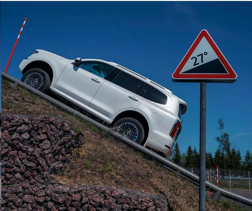
Угол въезда – почти 30°, углы съезда и рампы – по 24°. На бездорожье «вывозит» не только геометрия, но и неплохо настроенная электроника, включая функцию «танкового разворота» и «ползучий» круиз-контроль. Последний, правда, не умеет ездить медленнее 3–4 км/ч – а кое-где это нужно. Спереди и сзади – по одной стационарной буксирной петле.
