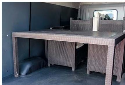
Грузовой отсек при конфигурации L2H1 вмещает четыре стандартных европалеты. Или десять кубометров груза.
