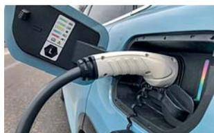
Электромобили Free идут с европейским разъемом CCS Combo, тогда как на гибридных модификациях он китайского формата GB/T.
