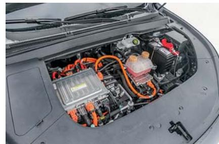
У машины три контура систем обогрева: для электромотора, тяговой батареи и салона. Этот i-Sky предсерийный, поэтому дизельной «автономки» для отопления салона нет. На серийных – будет.
