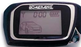
Самое сложное в этом способе – дождаться времени 23:59 и вытащить батарейку. Через десяток секунд устанавливаем элемент питания на место и видим на часах 0:00 – всё готово!
