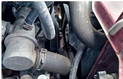
Двигатель держится, но патрубки системы охлаждения были заменены из-за трещин.
