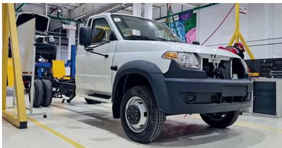
Цех крупноузловой сборки разбит на пять тактов. На первом монтируются главные электрические элементы. На последнем проводится контроль всех выходных параметров.
