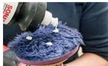
Царапины и риски удаляем кругом с небольшим количеством саморазрушающегося полировального состава.
