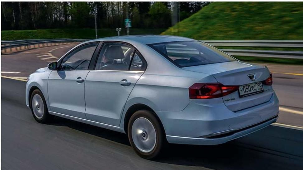
Москвич симпатичен. LED-фары и 18-дюймовые колеса стоят на электромобиле по умолчанию. В бампере есть заглушка под радар систем активной безопасности, но такого оборудования на модели пока нет. На леворульной машине зарядный порт оказался в левом переднем крыле, со стороны дороги.
