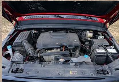
Мотор E20CB закреплен высоко – торчит выше уровня крыльев. У него чугунный блок и цепь ГРМ. Одобряем. Как и аккумулятор на 70 А.ч. А вот сеточку перед радиатором не мешало бы сделать погуще – владельцу придется ставить дополнительную. Под капотом грязь: расширенной защиты днища не хватает, да и уплотнители идут не сплошняком.
