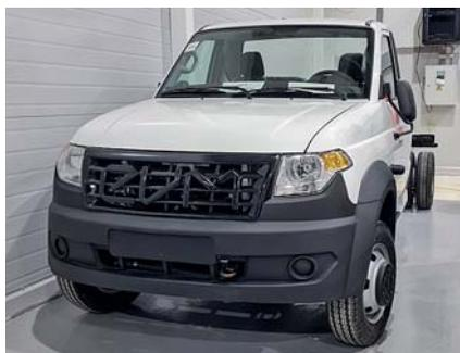
На серийных автомобилях стоит пластиковая решетка радиатора со своей эмблемой. Во время нашего прошлого знакомства на EVM Pro стояла металлическая с вырезанными на лазерном станке буквами.
