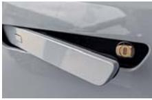
**Выдвижные ручки** сделаны диагональными. Прямые удобнее. В прорези видна скважина для открывания по старинке, ключом.
