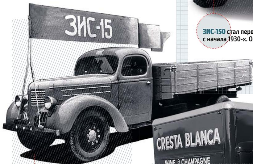
Предком ЗИС-150 был предвоенный опытный **ЗИС-15**. Несколько прототипов сделали в самом конце 1930-х. В основном ЗИС-15 отличался от ЗИС-5 именно кабиной и увеличенным бензобаком. На одном из прототипов стоял серийный мотор в форсированной версии. Кабину ЗИС-15 сделали под влиянием американских аналогов. Больше всего она похожа на кабину Dodge серии D.
