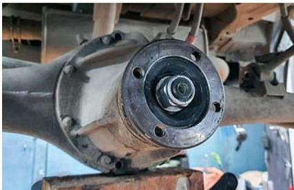
Ослабевающая гайка хвостовика заднего редуктора – обычное дело.
